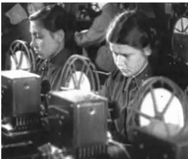
Узел связи. Работа телеграфиста на аппарате Бодо.
